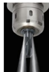
Con función de refrigerante por los costados con boquilla MC-C
