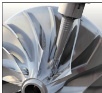
Acabado en fresa cilíndrica en máquina de 5 ejes Finishing with ball endmill on 5-axis machine
