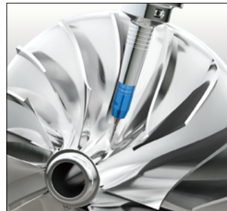
Máquinado en fresa en espacios angostos ( para impulsor etc) Taper Endmill Machining ( for Impeller etc)
