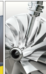
Acabado en fresa cilíndrica en máquina de 5 ejes Finishing with ball endmill on 5-axis machine
